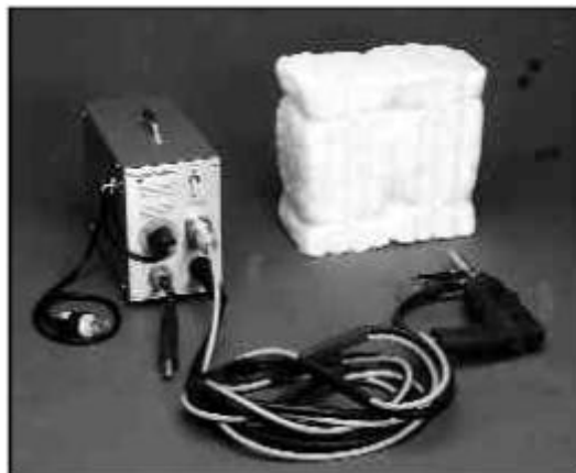
Figura 1. Módulo Fold con caja de control y pistola de soldadura.
