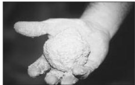
Figura 5. Prueba de Bola en Mano.
